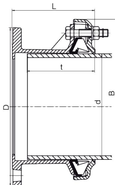
Dichtung EPDM, DIN-EN 681-1 / KTW / UBA / DVGW-W270
