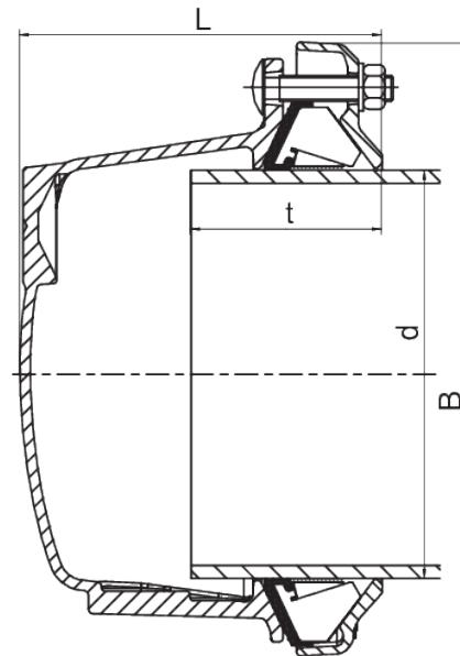
Dichtung EPDM, DIN-EN 681-1 / KTW / UBA / DVGW-W270
